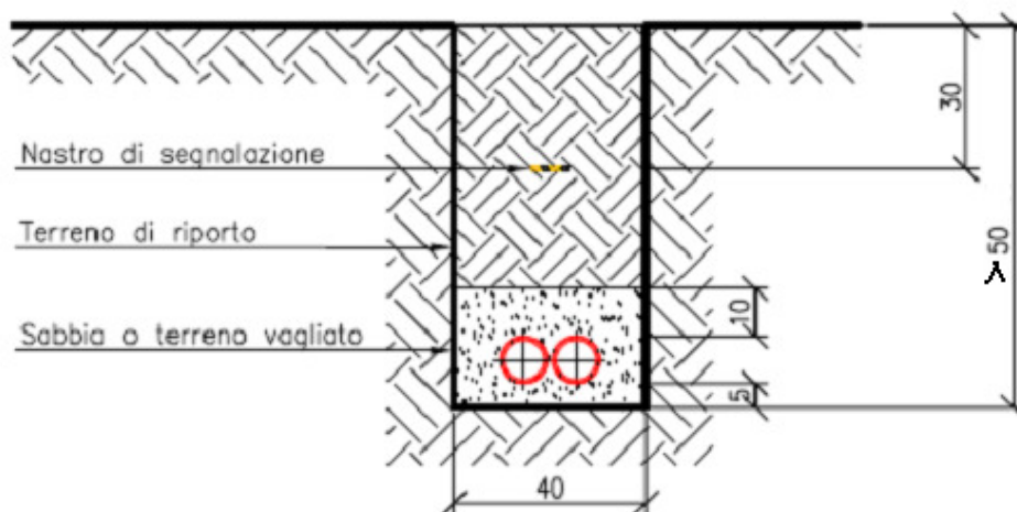
Figura 4 - Sezione tipo scavo tradizionale su terreno
