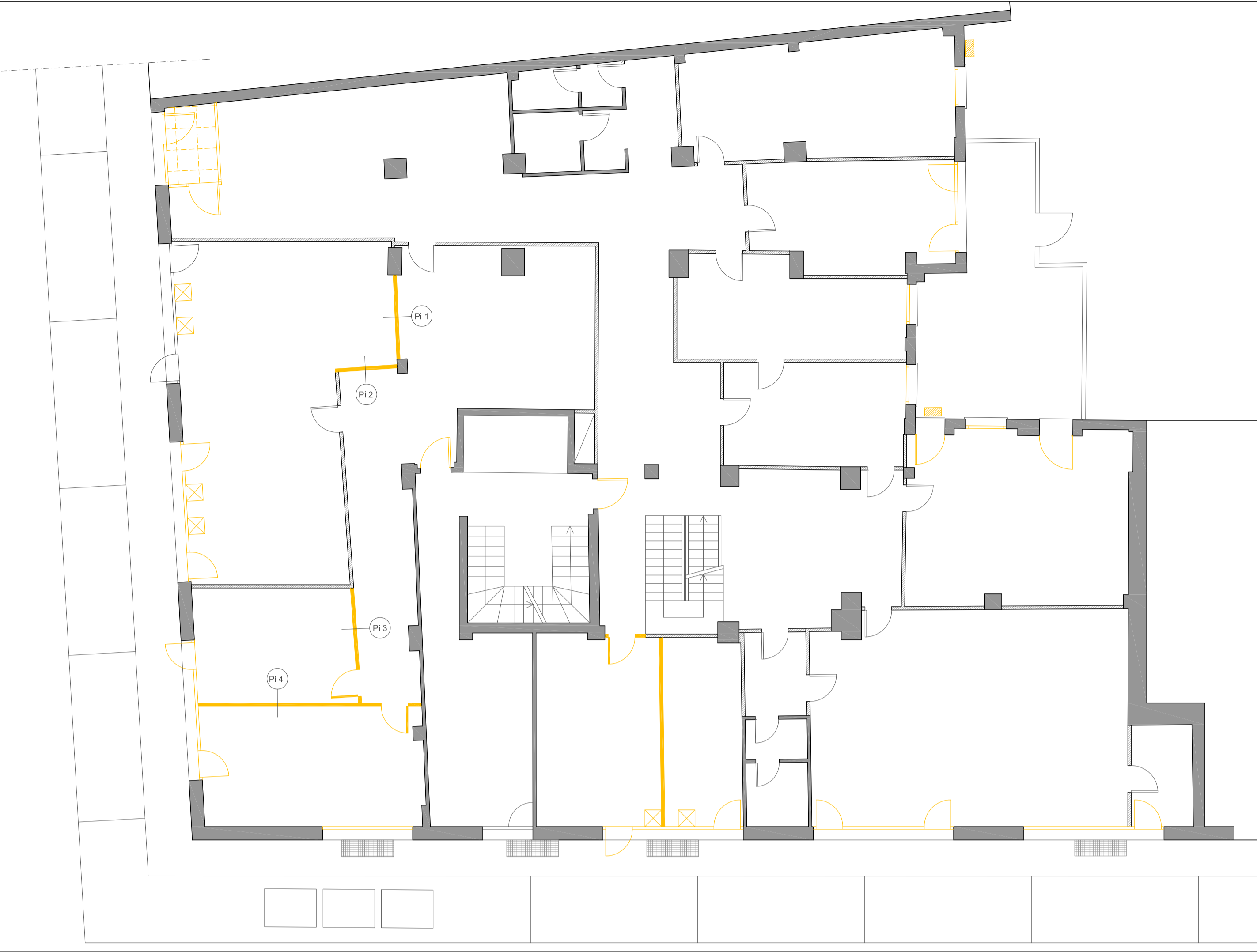
DEMOLIZIONI PIANTA PIANO TERRA
