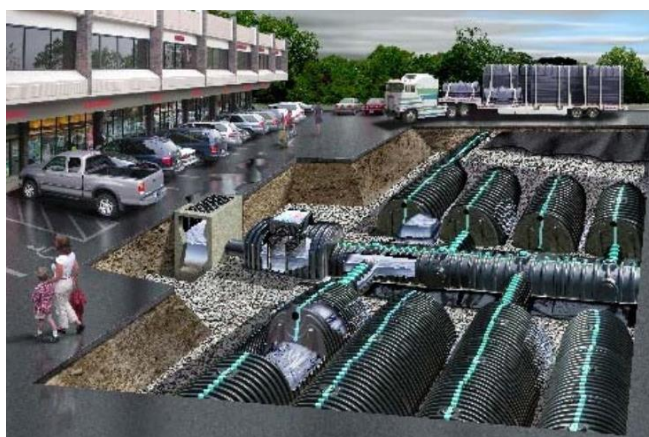
Figura 15. Invasi sotterranei in super tubi (Figura tratta dal contributo “Come affrontare il rischio idraulico nella pianificazione urbanistica”, di A. Paoletti, http://www.csdu.it/CONVEGNI/2011/CREMONA/Cremona%2711_Paoletti-csdu-PoliMI_pres.pdf ).
