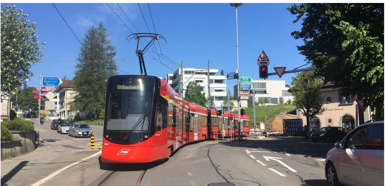
Fig. 21 – Veicolo tram-treno su un tratto a singolo binario adiacente alla carreggiata stradale
