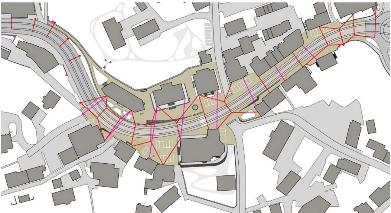
Fig. 17 – Nuovo tracciato urbano di Teufen, disposizione dei sostegni della linea di contatto
