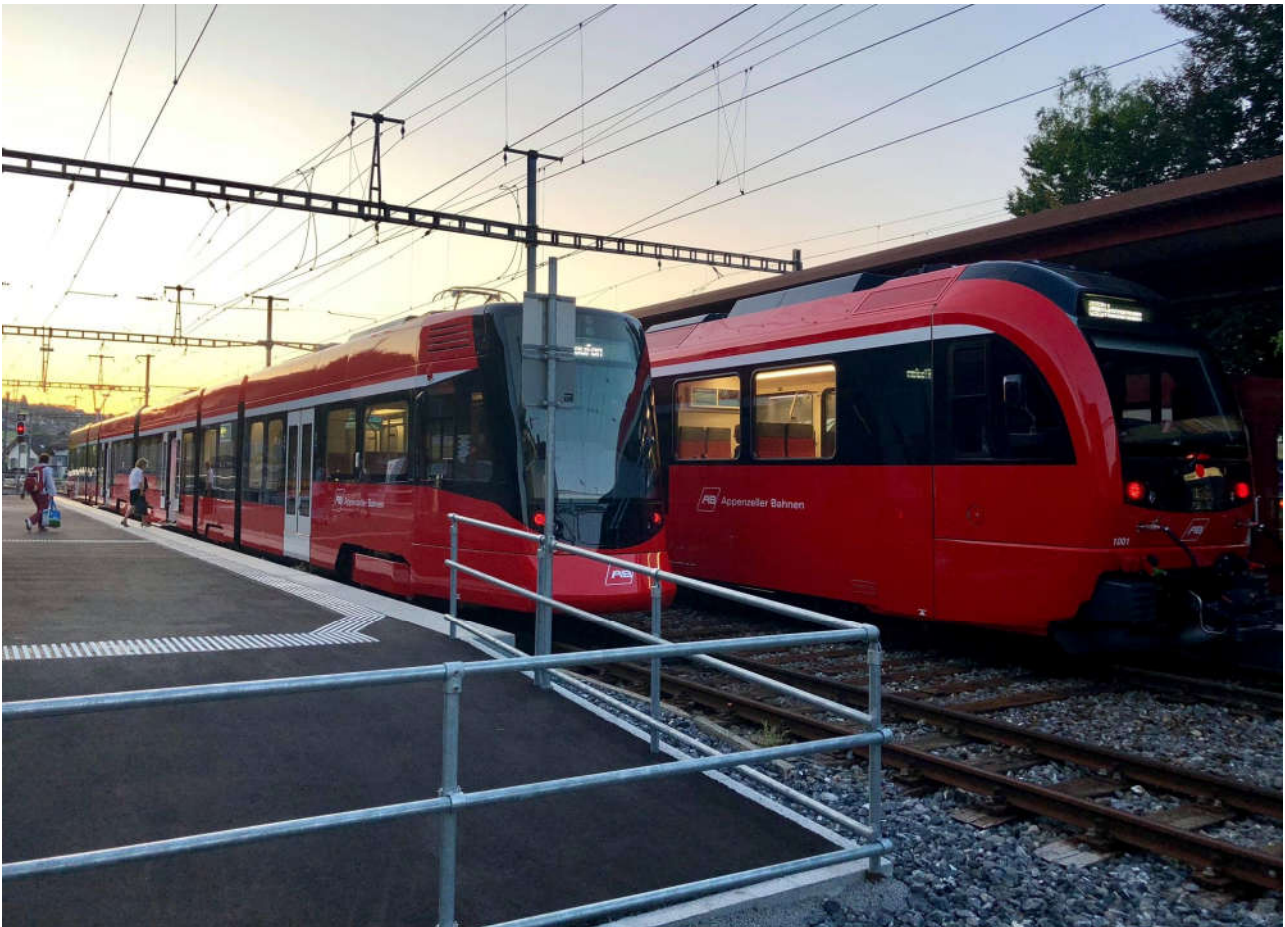
Fig. 21 – Veicolo tram-treno su un tratto a singolo binario adiacente alla carreggiata stradale
