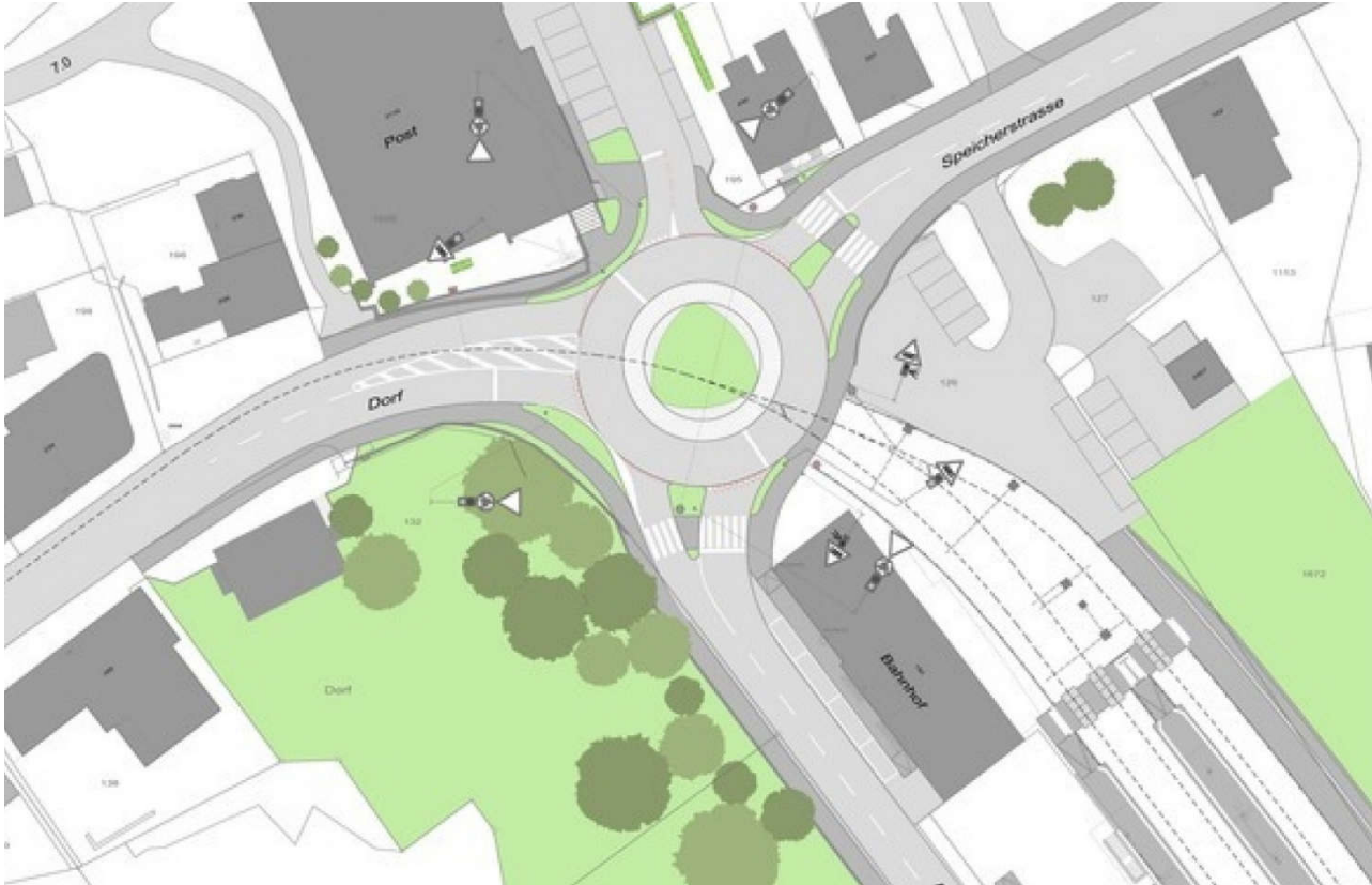
Fig. 17 – Nuovo tracciato urbano di Teufen, disposizione dei sostegni della linea di contatto
