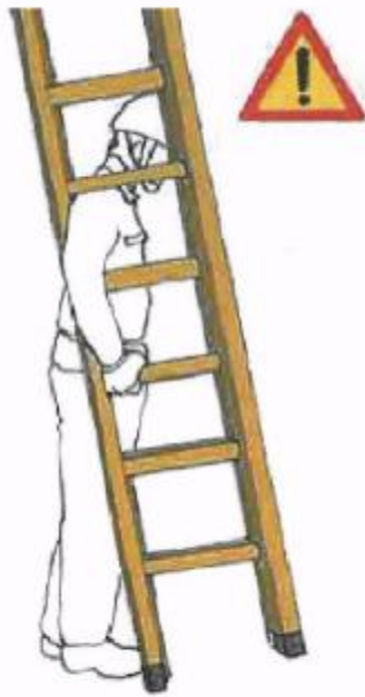
Modalità errata di trasporto della scala a spalla
