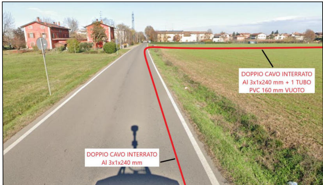
Foto 4: Linea interrata in percorrenza di via Bassetta
