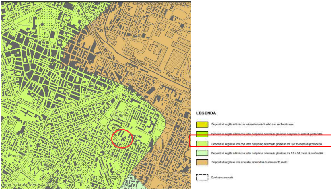
Figura 6: Carta Litologica tratta dalla tav. n. 3, approfondimento QDC_E, del PUG del Comune di Reggio Emilia - stralcio in scala grafica
