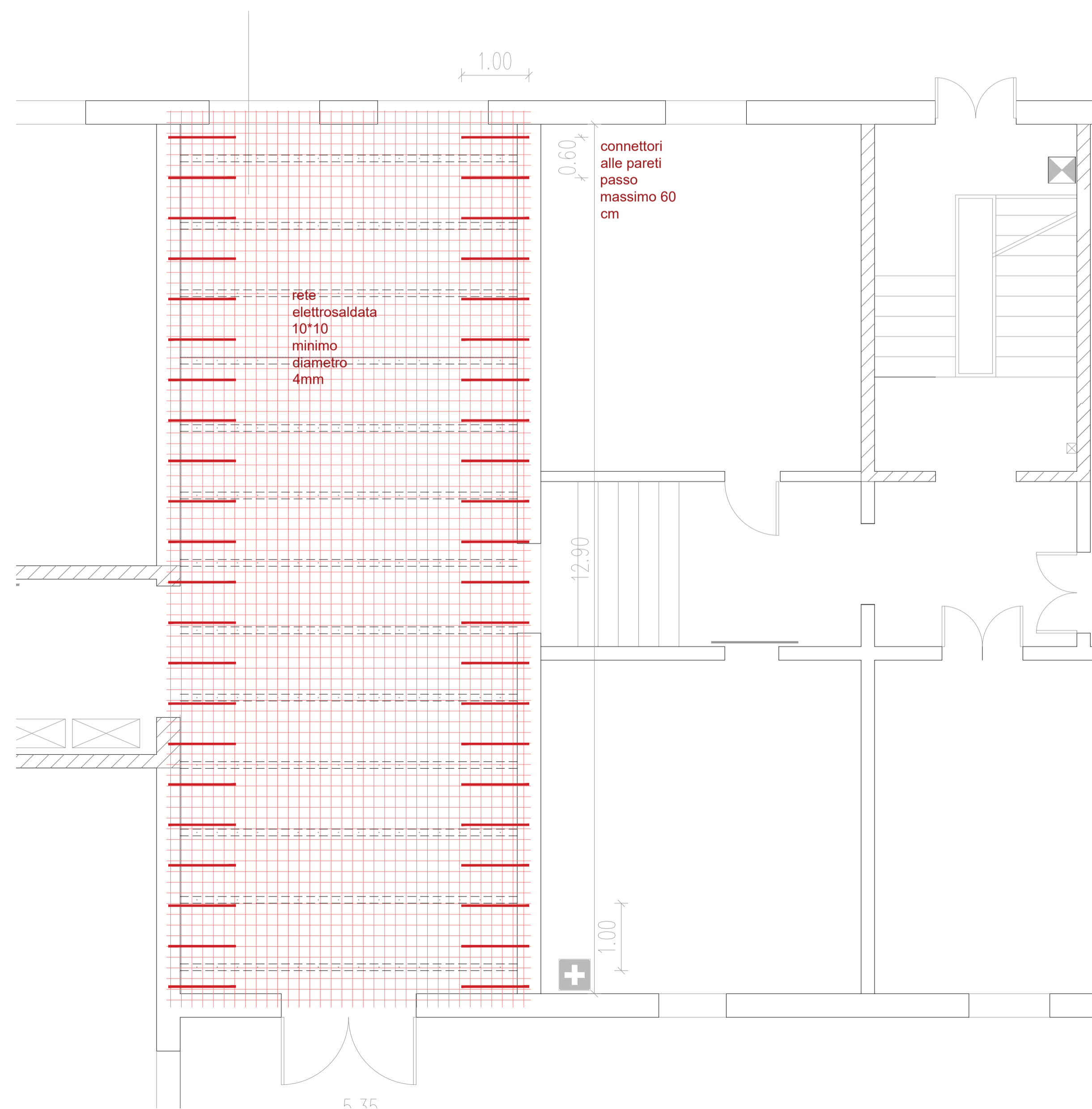
Planimetria con distribuzione connettori, putrelle e rete elettrosaldata
