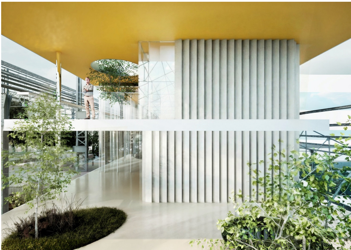
Visualizzazione del rivestimento esterno in lamiera sagomata di alluminio anodizzato satinato
